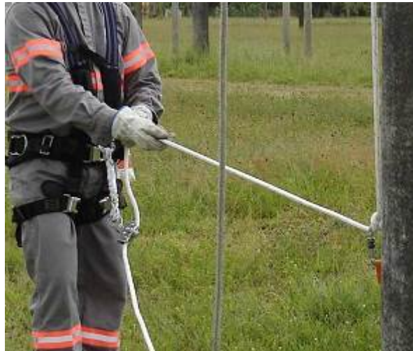
Figura 40 – Acionamento do nó de freio
