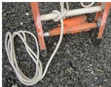
Figura 18 – Nó fiel na base da escada
