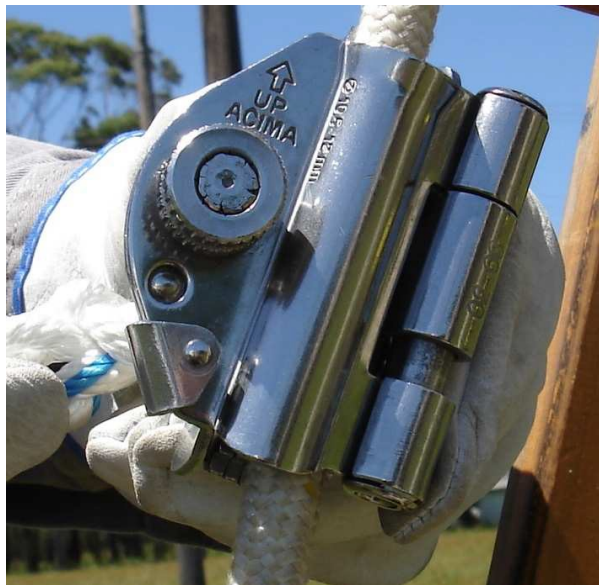
Figura 35 – Fechamento e travamento do trava-quedas
